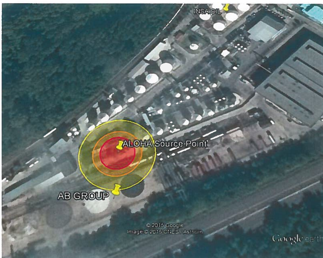
Фиг. 3.2. Зони на въздействие при факелното горене на водород
