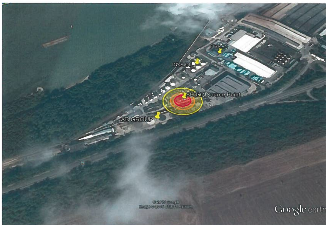
Фиг. 2.2. Графично представяне на зоните на поражения върху площадката на „ПОЛИСАН“ АД
