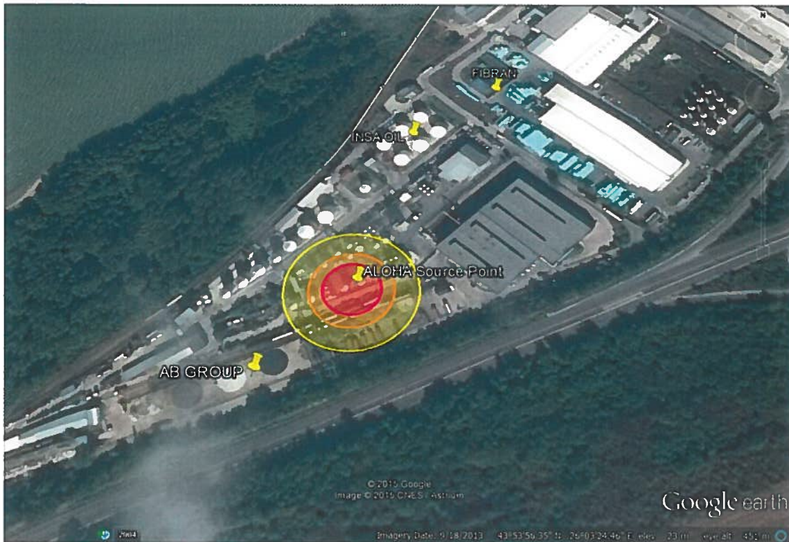
Фиг. 1.2. Въздействие на пожара от повърхността на разлив от дизелово гориво върху площадката на „ПОЛИСАН“ АД и съседните обекти
